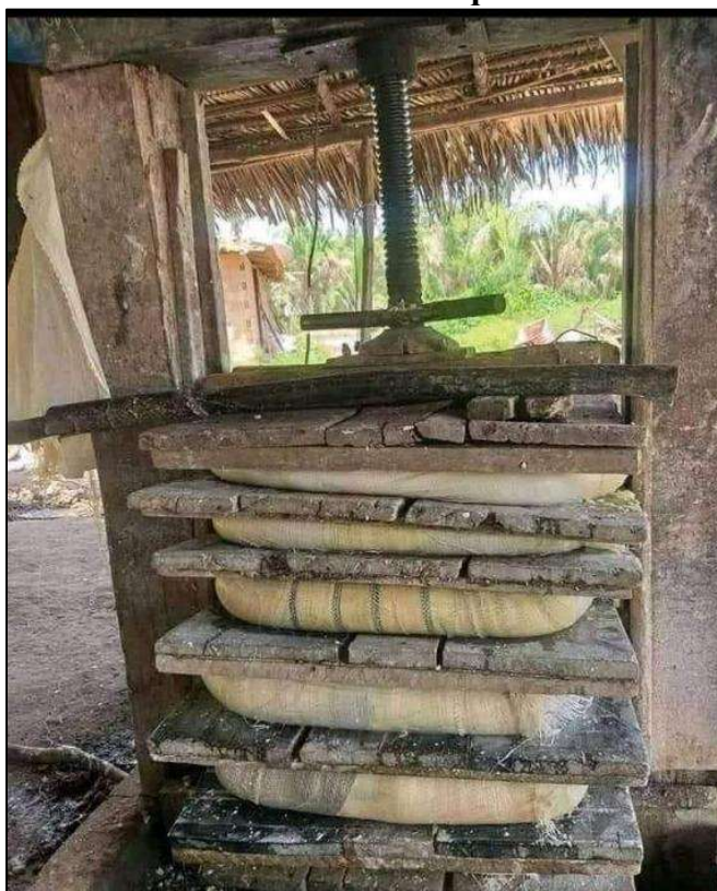
Figura 10 – Prensa artesanal manual que tem a mesma função
