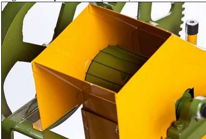
Figura 7 – Máquina de ralar (triturar) as raízes da mandioca
