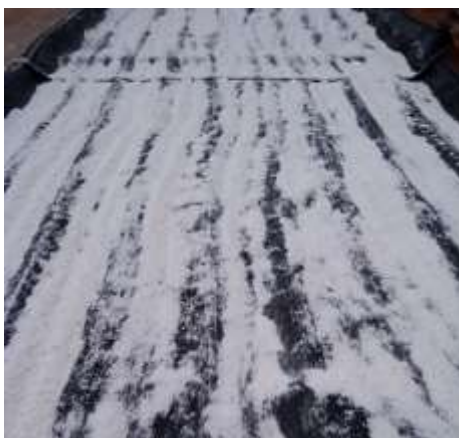
Figura 4. Processo de secagem do polvilho em jiraus.
