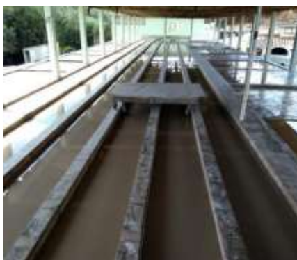
Figura 2. Decantadores utilizados para a sedimentação do amido.
