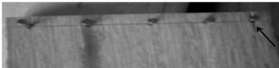
**Figura 4.** Presença de rachadura no fendilhamento por prego
