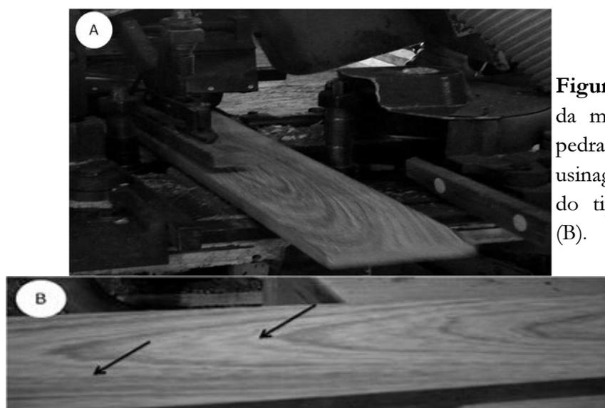
**Figura 1.** Aplainamento da madeira de Angelim pedra em teste de usinagem (A); Detalhes do tipo da grã reversa (B).
