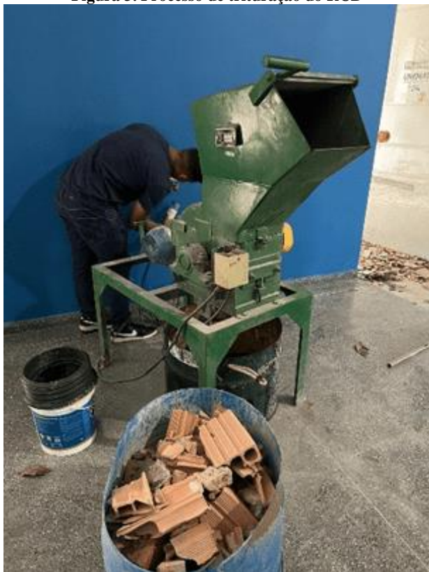
Figura 3. Processo de trituração do RCD
