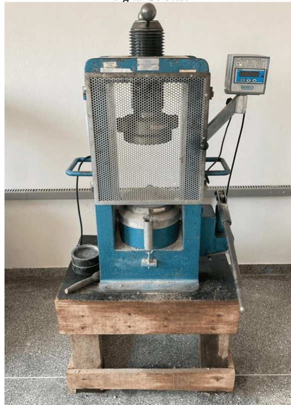
Figura 7. Prensa hidráulica Pavitest 1075, com indicador digital Solotest
