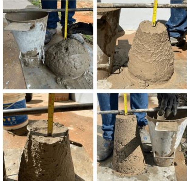
Figura 10. Realização de ensaios de abatimento do concreto
