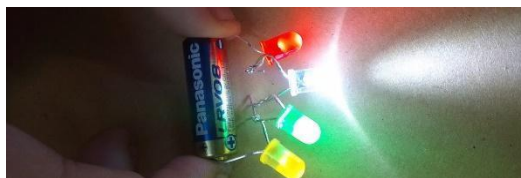
Figura 02: Circuito em Série com LED
